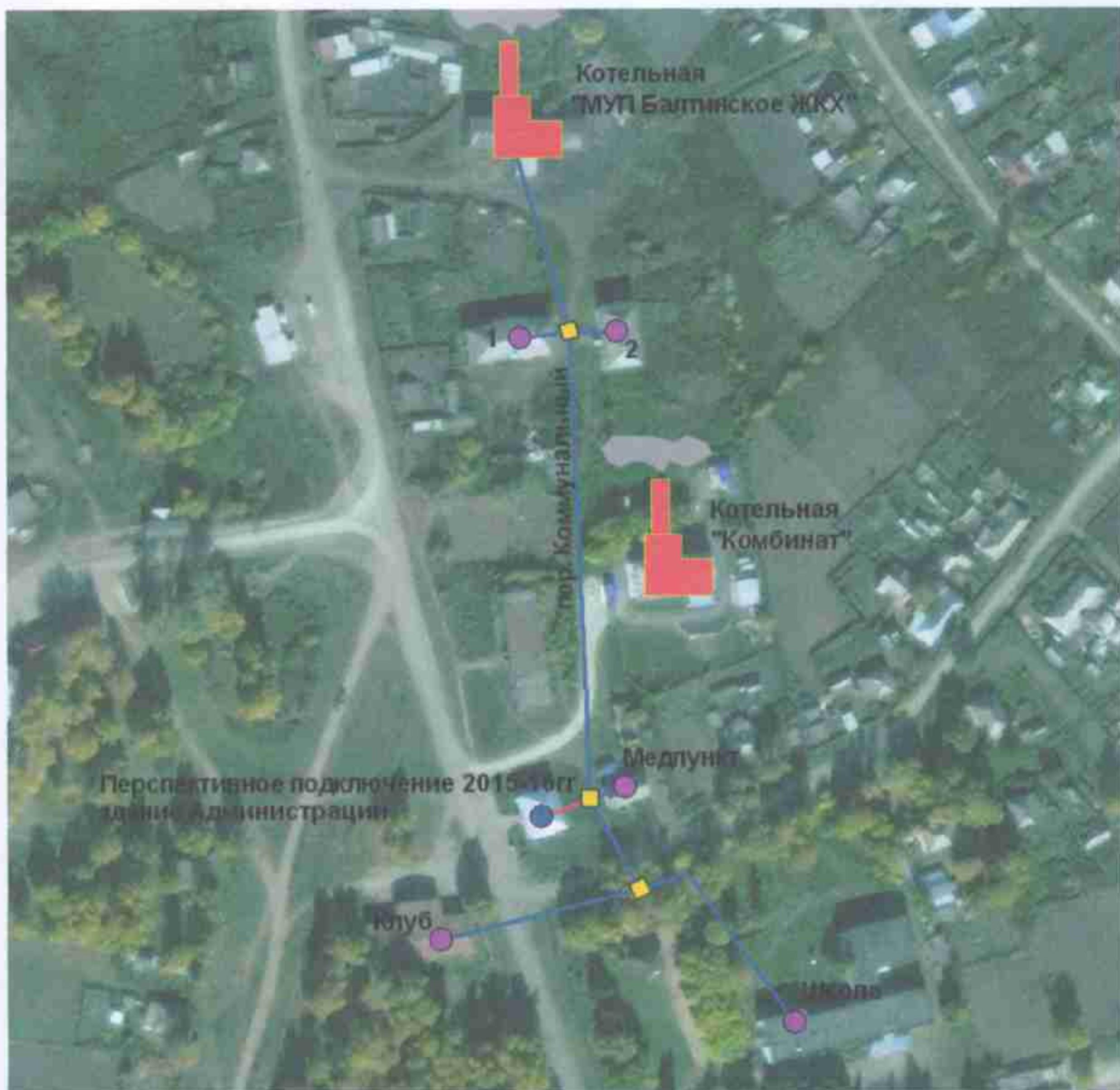
Рисунок 2 – Схема тепловых сетей деревни Балта
